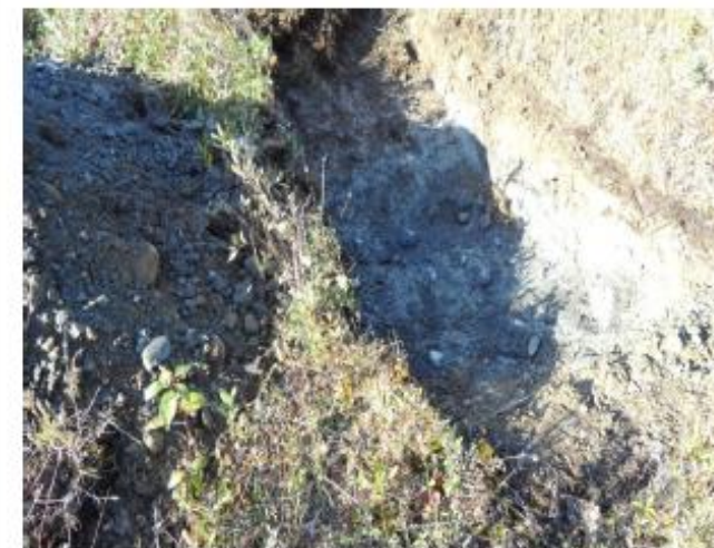
Photo 4. Sol naturel dans la tranchée d'exploration TE-3
