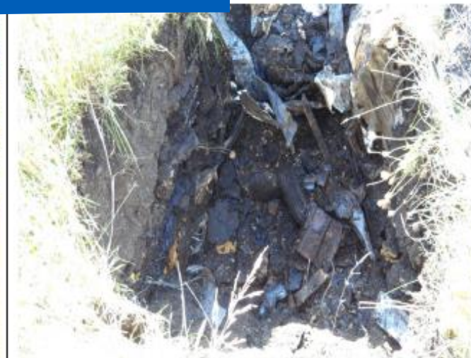
Photo 2. Vue du remblai dans la tranchée d'exploration TE-1 (résidus métalliques, bardeaux d'asphalte, etc.)
